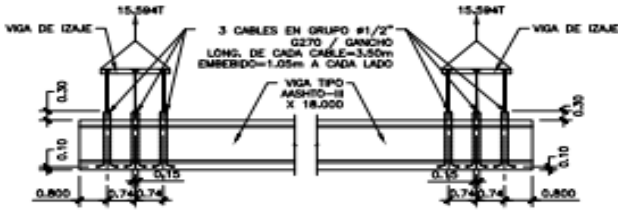
PUNTOS DE IZAJE ESCALA 1:75
