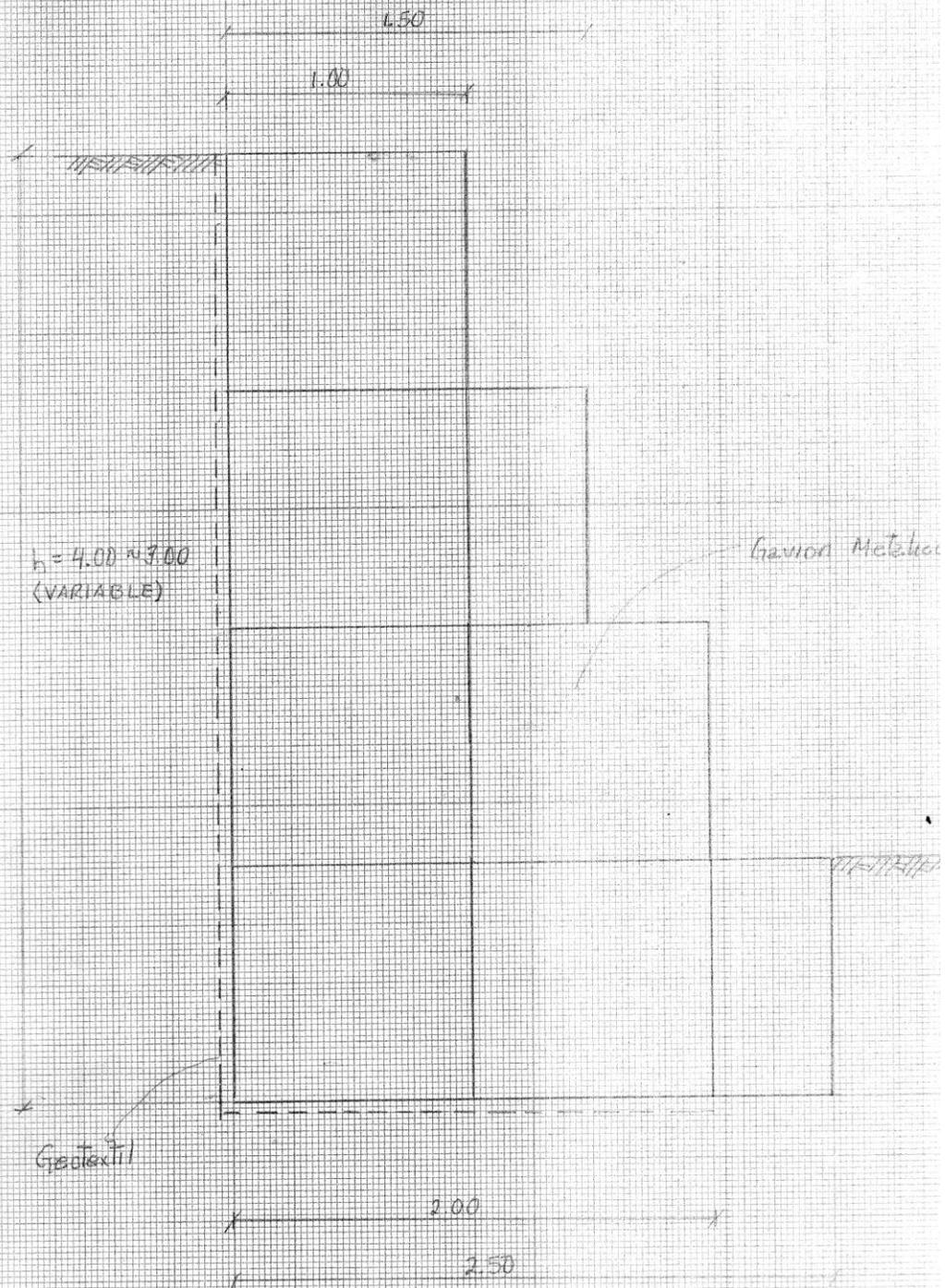
NOTA: UTILIZAR GAVION METÁLICO (2.1mm)
