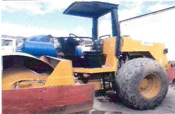
VIBRO COMPACTADOR DE 8 TON
