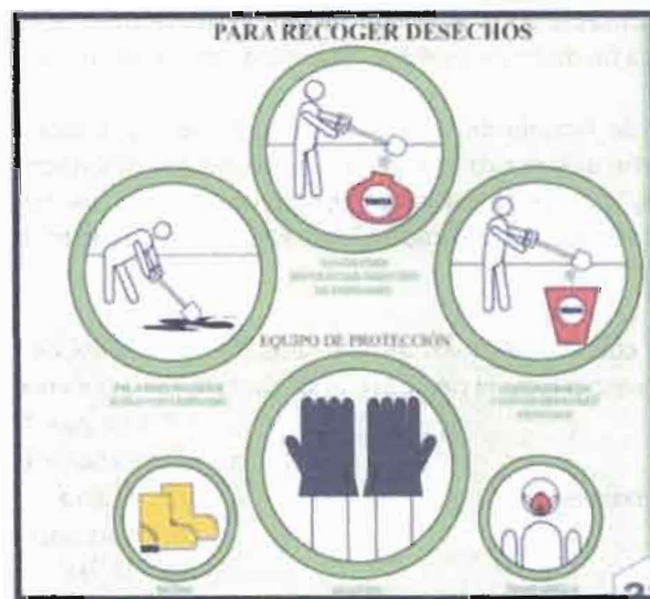
Imagen 13. Pasos para la recolección de desechos del derrame
