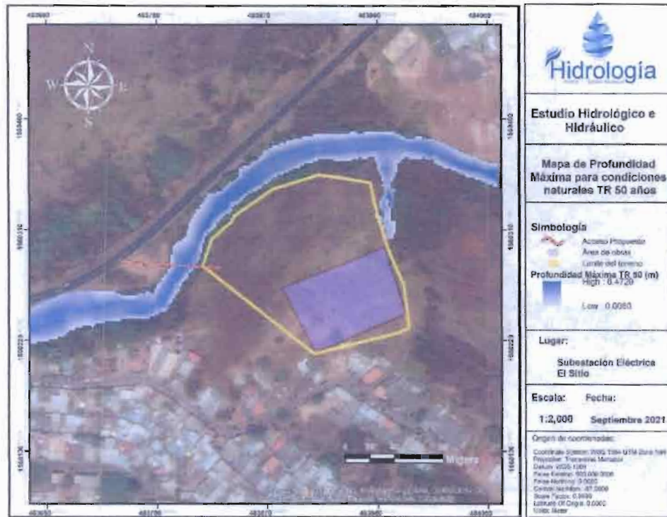
Ilustración 16 - Profundidad máxima para las condiciones naturales TR 50 años
