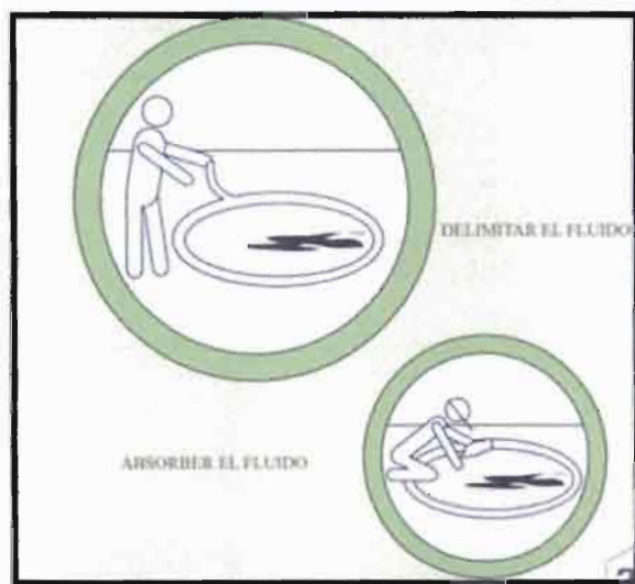
Imagen 14. Pasos para el control del derrame en superficies de concreto
