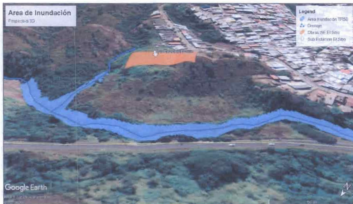
Ilustración 27. Representación tridimensional de la lámina de inundación para un periodo de retorno de 50 años.
