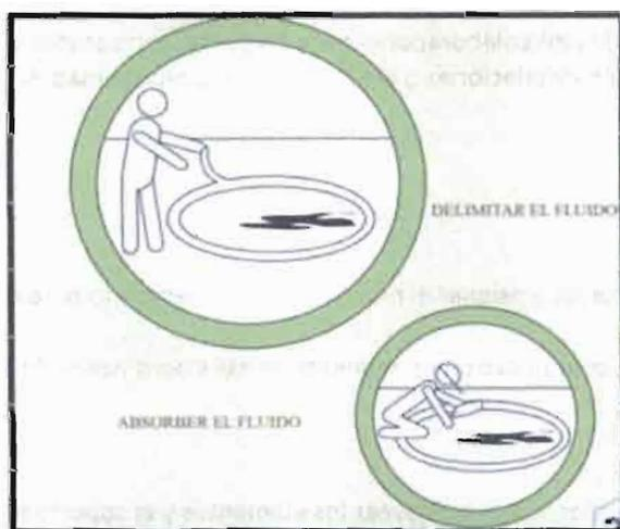
Imagen 7. Pasos para el control del derrame en superficies de concreto
