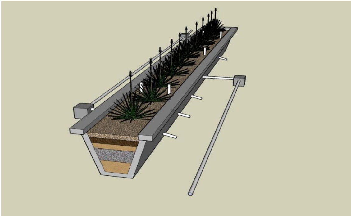
Detalle Longitudinal Bio-Filtro Vertical
