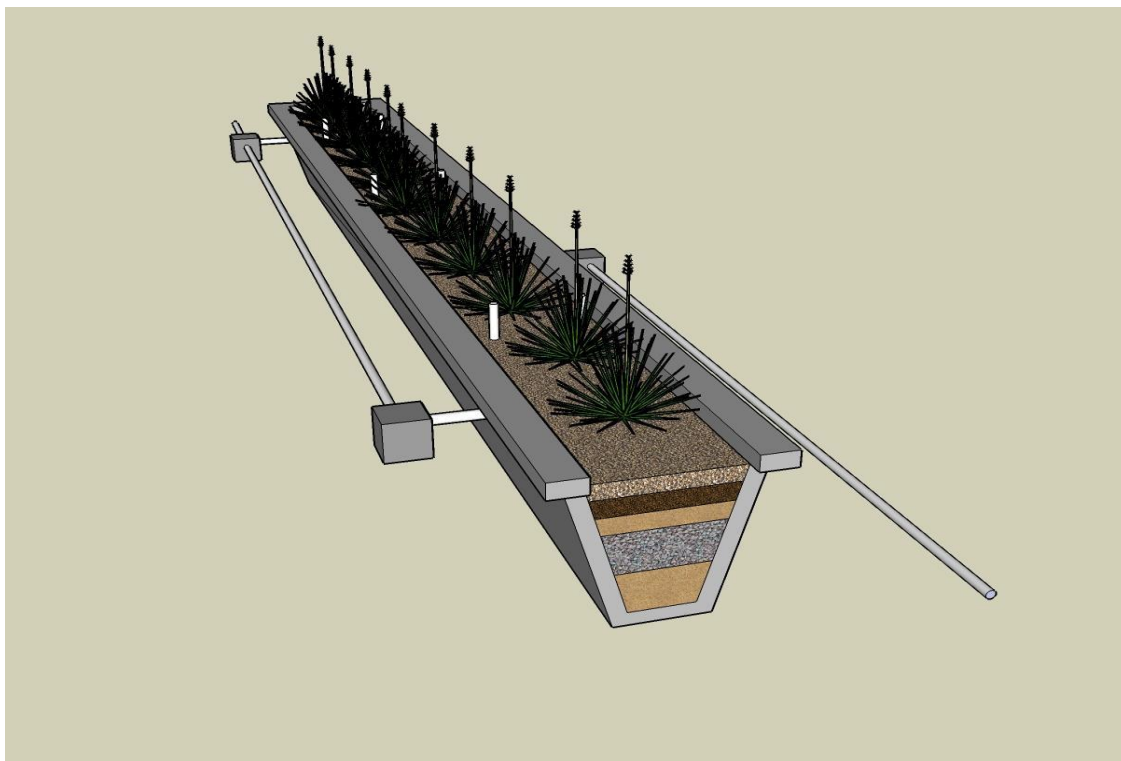
Detalle Longitudinal Bio-Filtro Vertical
